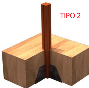
FIJACION A SUELO BLANDO
