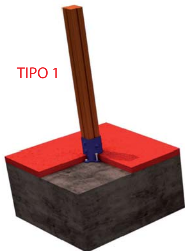
FIJACION A SOLERA DE HORMIGON
