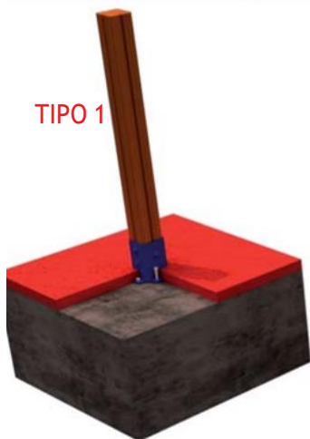
FIJACION A SOLERA DE HORMIGON
