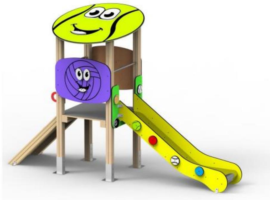
**DESCRIPCIÓN** Conjunto infantil con forma de pelotas, estructura de madera laminada 90x90 mm nivel 4 con tratamiento lasur, paneles HDPE y rampa de acero inoxidable o HDPE, actividades lúdicas para deslizarse, trepar, relacionarse y juego por turnos, diseñado para edades comprendidas entre 0-3, capacidad hasta 4 usuarios, dimensiones 2,40 m x 3,50 m, area de seguridad requerida 5,00 m x 4,00 m, UNE-EN-1176 emitido por ACCM
