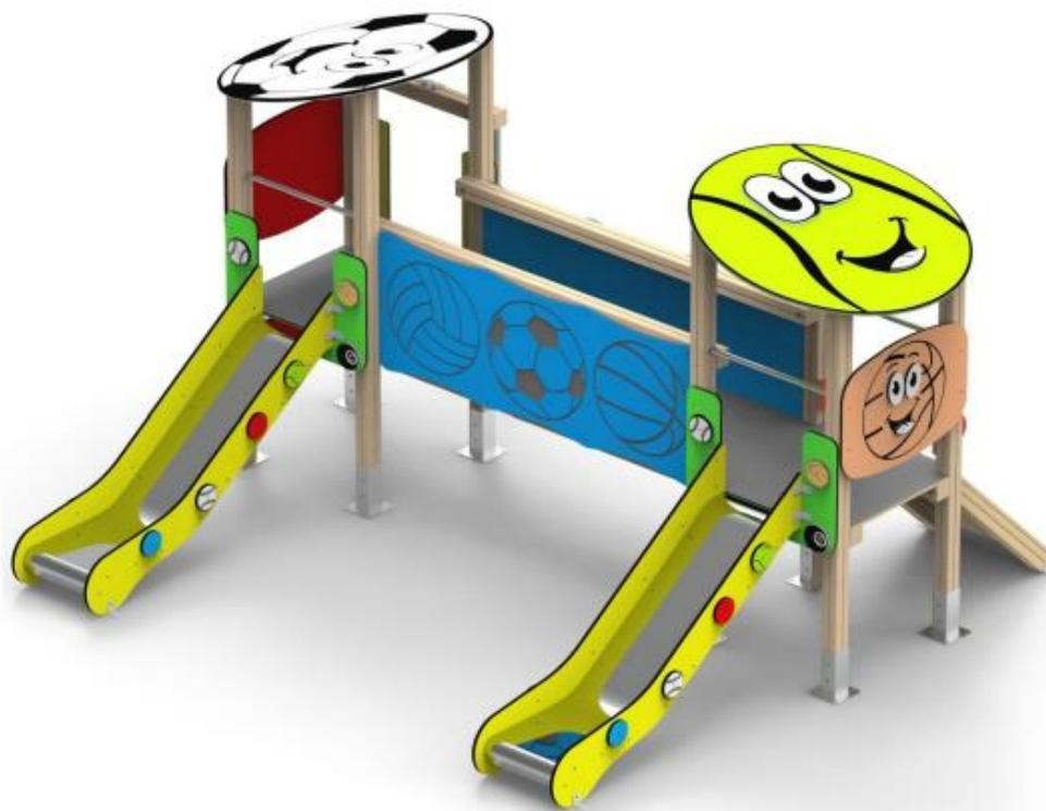
**DESCRIPCIÓN** Conjunto infantil con forma de pelotas, estructura de madera laminada 90 x 90 mm nivel 4 con tratamiento lasur, paneles HDPE y rampa de acero inoxidable o HDPE, actividades lúdicas para deslizarse, trepar, relacionarse y juego por turnos, diseñado para edades comprendidas entre 0-3, capacidad hasta 6 usuarios, dimensiones 2,45 m x 4,35 m, area de seguridad requerida 8,00 m x 5,00 m, UNE-EN-1176 emitido por ACCM
