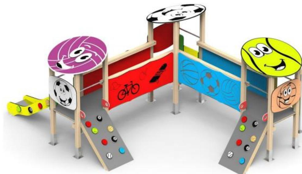
**DESCRIPCIÓN** Conjunto infantil con forma de pelotas, estructura de madera laminada 90x90 mm nivel 4 con tratamiento lasur, paneles HDPE y rampa de acero inoxidable o HDPE, actividades lúdicas para deslizarse, trepar, relacionarse y juego por turnos, diseñado para edades comprendidas entre 0-3, capacidad hasta 8 usuarios, dimensiones 2,40 m x 5,75 m, area de seguridad requerida 9,00 m x 5,00 m, UNE-EN-1176 emitido por ACCM
