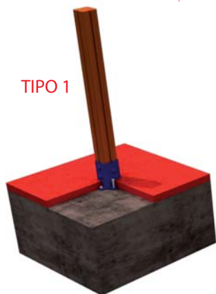
FIJACION A SOLERA DE HORMIGON
