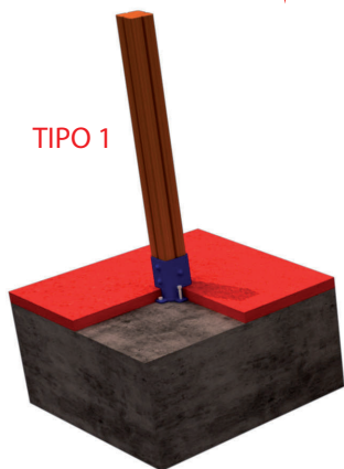
FIJACION A SOLERA DE HORMIGON
