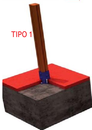
FIJACION A SOLERA DE HORMIGON
