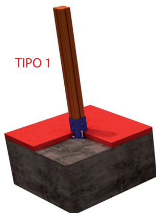
FIJACION A SOLERA DE HORMIGON
