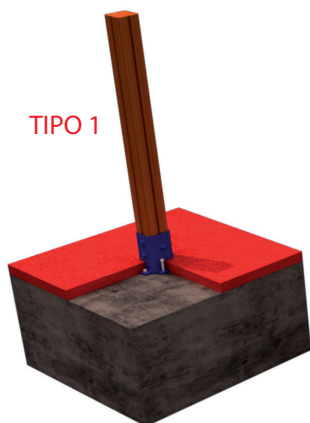
FIJACION A SOLERA DE HORMIGON
