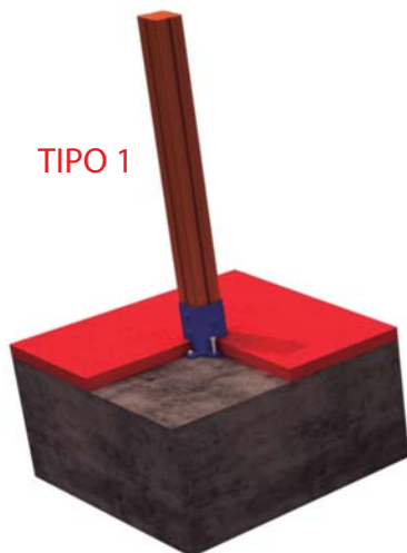
FIJACION A SOLERA DE HORMIGON
