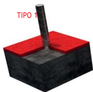
FIJACION A SOLERA DE HORMIGON
